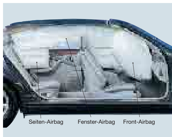
Abb. 3: Anordnung der Airbags im Fahrzeug
